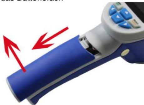
2. Entfernen Sie die alten Batterien und legen Sie neue Batterien ein.
